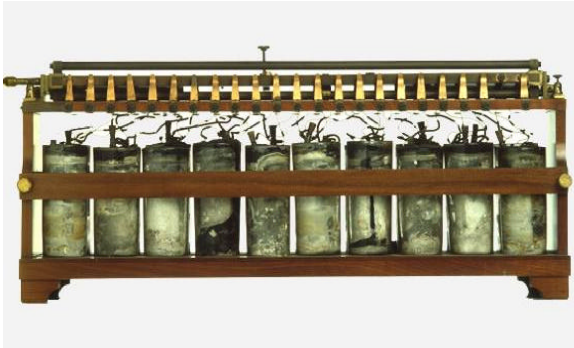
Figure 1 : Première batterie d'accumulateurs conçue par Gaston Planté
